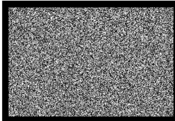
Abb. 3.6: Projiziertes Muster aus semirandomisierten Punkten mit 50% Dichte
