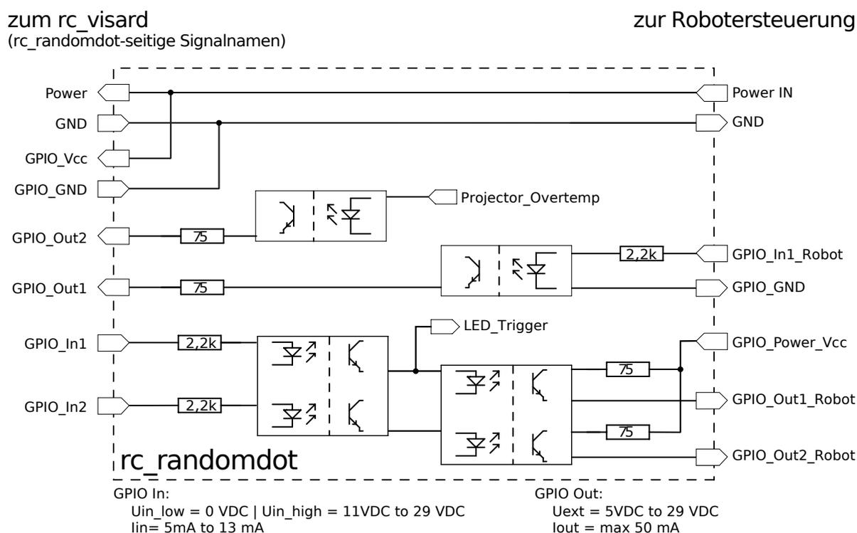
Abb. 3.4: GPIO-Schaltung und -Spezifikationen – keine Signale höher als 29 V anschließen
